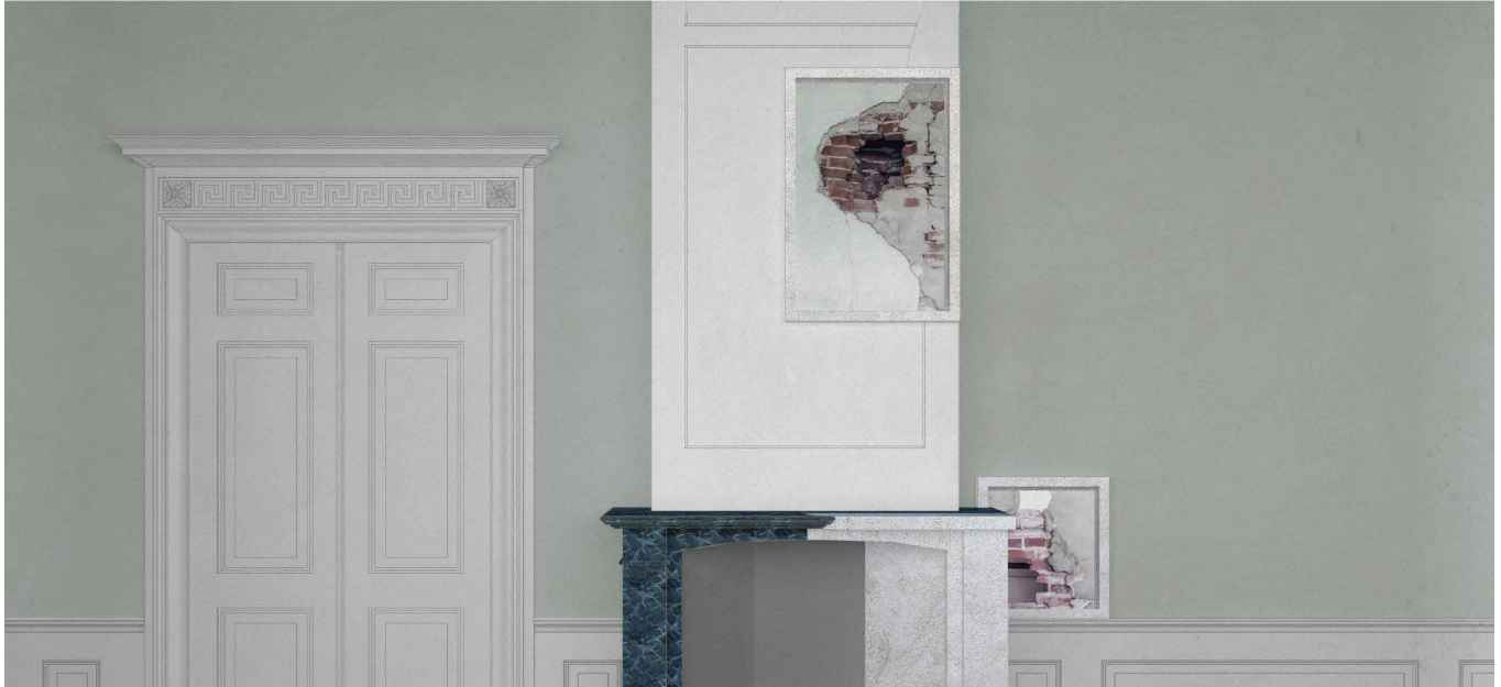
AFB. 5.9 Een voorstel in een afstudeerproject voor Reuversweerd om op een aantal plaatsen de oorlogsschade in het zicht te laten door het te omlijsten (Johannes Düber).
