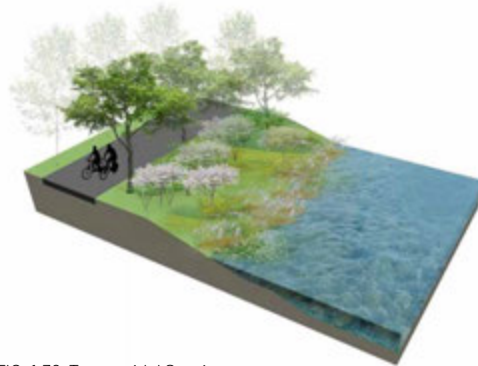
FIG. 1.39 Trapezoidal Section 人工生态型断面
