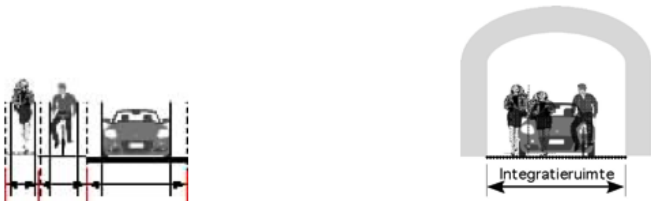
Fig. 216 en 217 LINKS Zeer brede verkeersruimte ontstaan als we willen dat iedere verkeerssoort vrijelijk kan 'stromen'. Daartoe zal de verkeerskundige alle voertuigbreedten plus de schrikbreedtes (Zie de rode maatlijntjes) sommeren .
