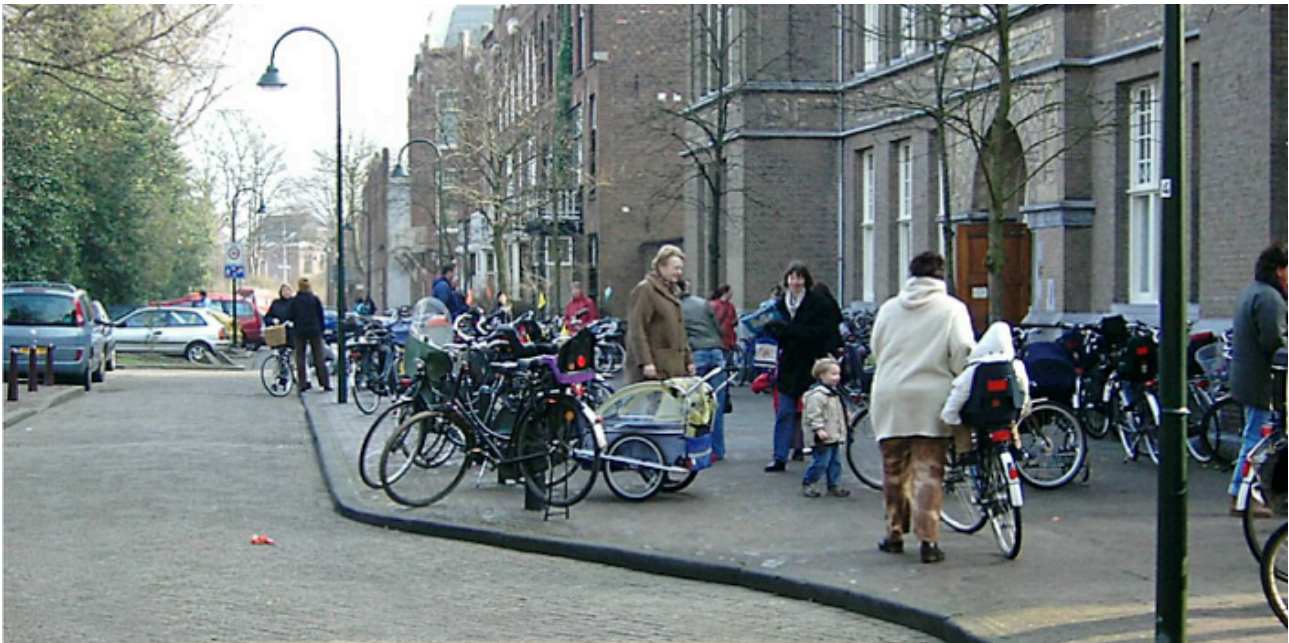
Fig. 158 j Op het Koningsplein in Delft is de rijstrook aan de voorzijde van het schoolgebouw een paar meter verschoven. Daardoor is een plein ontstaan, met een paar bankjes en enkele nieuwe bomen, waar ouders elkaar, voor en na schooltijd, treffen. Deze 'kronkel' nodigt uit tot snelheidsvermindering en vestigt gelijktijdig aandacht op een monumentaal gebouw waar je anders gemakkelijk aan voorbij gaat.
