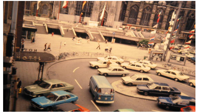
Fig. 377 en 378 LINKS De Stedenbouwkundige detaillering rond stations wordt sterk bepaald door systeem eisen zoals taxistandplaatsen, Kiss & Ride voorzieningen en draaicirkels en het type opstelling van (bus)platforms en bus/taxi buffers. (Met dank aan T. De Jong) RECHTS De uitloop van Hauptbahnhof Köln (D) heeft een TAXI / Kiss & Ride lussen.
