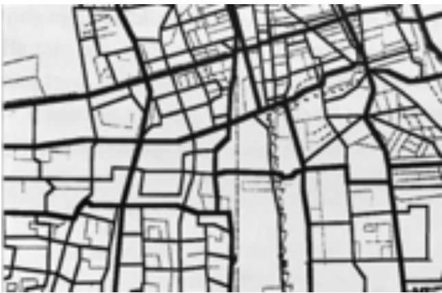
Fig. 72 en 73 LINKS Het Delftse Fietsplan op basis van de 'missing link' gedachte; het net is opgebouwd uit: stedelijke fietsroutes om verblijfsgebieden (kamers) van \pm 500 \times \pm 500 \text{m} locale fietsroutes om verblijfsgebieden (kamers) van \pm 250 \times \pm 250 \text{m}
