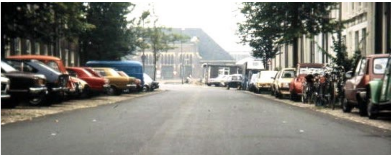
Fig. 194 Vanuit de idee dat autoverkeer moet stromen heeft men jarenlang profielen opgedeeld in stroken. Het nadeel is dat de 'geleidende werking' die dat uitstraalt en de zekerheid dat de rijloper voor de auto 'van jouw is', een hogere rijsnelheid uitlokt. De ruimtelijke 'overmaat' is ook weer snelheidsverhogend, mede omdat iedereen aanneemt dat de anderen 'in de toegedeelde strook blijven'. Alhoewel de rijloper kleiner lijkt nam na het aanbrengen van de suggestiefietsstroken in deze Delftse straat het snelheidsverschil toe tussen auto's en fietsers.
