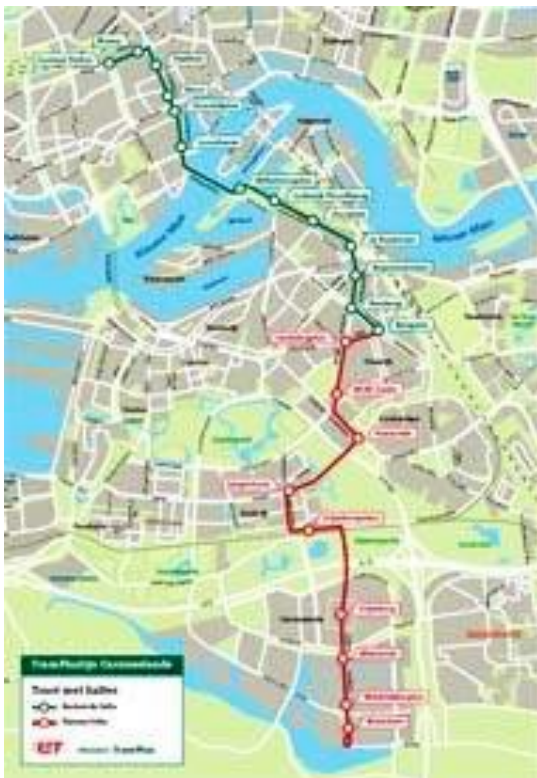
Fig. 354 In het kader van de opwaardering van het OV-net heeft Rotterdam tramlijn 23 opgewaardeerd tot een 'TramPlus' met meer vrije baan en een oprek van de gemiddelde halteafstand van 300 naar \pm 600 m, waardoor de zuidelijke VINEX-locatie Carnisse-Landen binnen het systeembereik kwam
