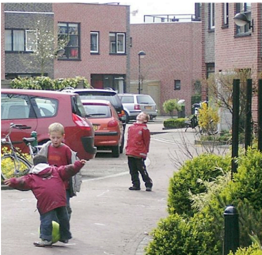
Fig. 163 a en b Woningen geïntegreerd met overganggebied (Rieteland & Liseiland te Rijswijk). Elke woning heeft een eigen garage op de begane grond met daarvoor een 2m. privé overganggebied waardoor de automobilist ver genoeg kan uitrijden om te zien of de straat vrij is en er bovendien ruimte is voor privé groen en/of een bankje.
