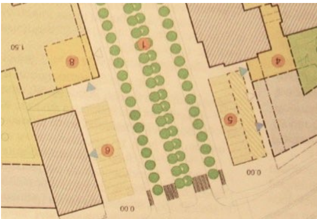
Fig. 237 en 238 LINKS Voorstel ombouw stedelijke stroomweg van 2 x 2 stroken tot boulevard van 2 x 1 strook (Vgl. LARGAS geïnspireerde 'Down-Grading'); vrijgekomen profielbreedte inzetten voor activiteiten langs de gevel en 2 centrale rijen bomen: Wibautstraat te Amsterdam. RECHTS '3-D' schets van een ombouw van een stedelijke stroomweg tot boulevard, ter informatie voor inspraak en bestuur over nieuwe ruimtelijke betekenis.
