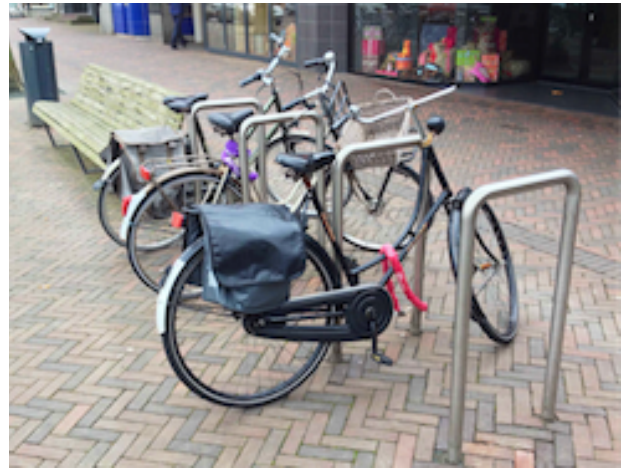
Fig. 501 serie Lineaire fiets-aanbindrekken. In de lengte of de dwarsrichting van de straat kan men het fietsparkeren ordenen met zgn.: FIETSNIETJES '.
