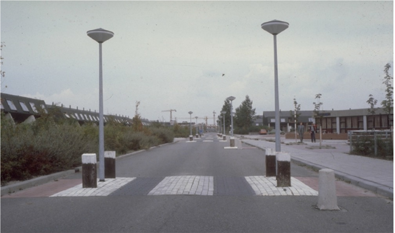
Fig. 135 a Joost Vahl 37 pakte Appleyard's onderzoek op als Stedenbouwkundig gemeente Delft en plaatste resterende bouwelementen, rioolbuizen en speelelementen in straten waar te snel werd gereden. De toegenomen ruimtelijke complexiteit drong doorgaand verkeer terug en dempte de rijsnelheid dempen. Zo kwam er gelegenheid voor kinderspel en burenerelaties in het publieke domein rond de woning .Het was de opstart van de echte 'Woonerven'.
