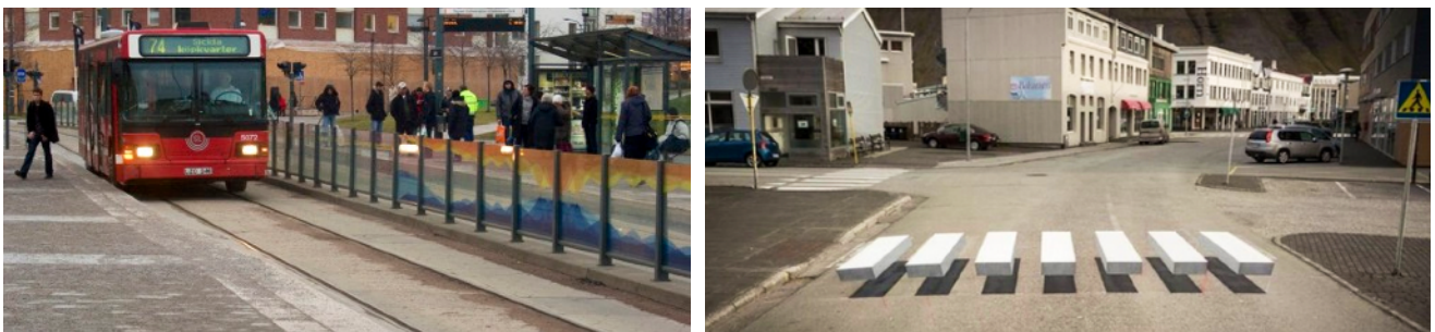
Fig. 433 en 434 LINKS Zweeds voorbeeld van ‘oversteek-omleiding’ naar één veilige plaats. RECHTS Een IJslands voorstel om met digitale techniek de zebra te projecteren zodat die zichtbaar blijft na sneeuwval.
