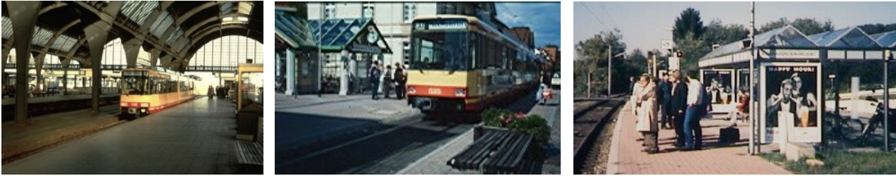
Fig. 337 t/m 339 LINKS In 1993 was hybride tramhaltering met verhoogd perron op DB-spoor in station Karlsruhe (D) voor velen een openbaring. MIDDEN Alleen bij weinig ruimte paste men enkelspoor toe over zo kort mogelijke baanvakken en in combinatie met haltes. RECHTS In voorstadhaltes verhoogt de combinatie van wachtruimte, overdekte fietsenstalling de publieke veiligheid.
