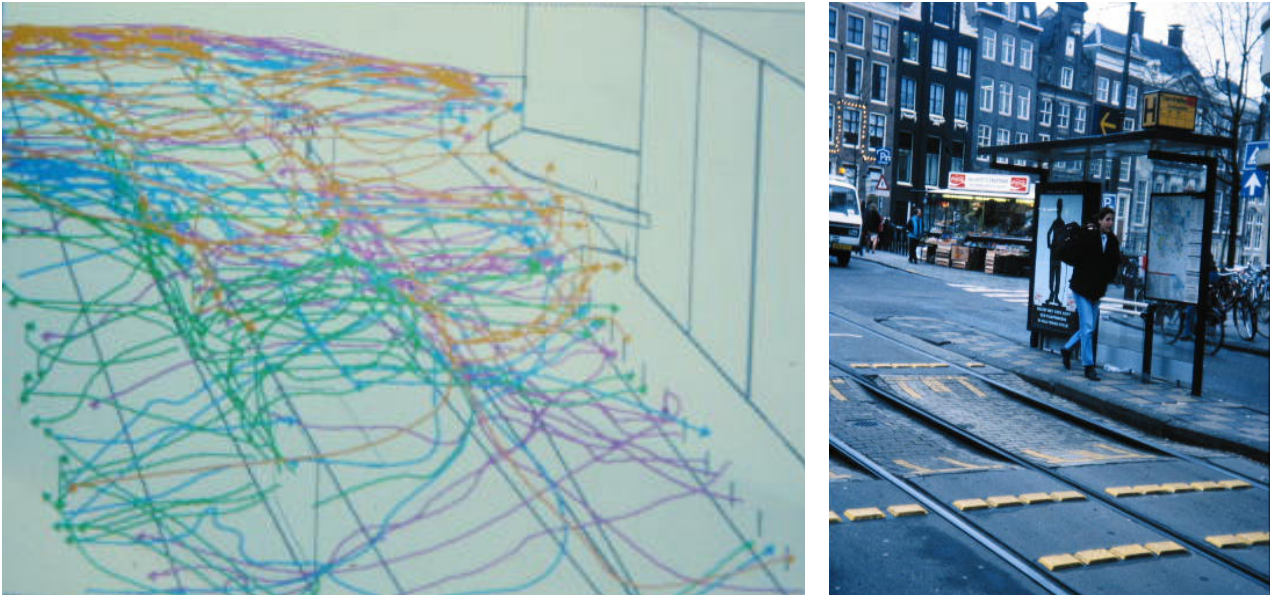
Fig. 362 en 363 LINKS Op Amsterdamse tramhaltes gebeurde ongelukken tussen taxi's op de OV-baan en uitstappende passagiers die (voor de tram langs) overstaken; Bach en Diepens 40 (1990) hebben op de Rozengracht te Amsterdam een Video-Analyse uitgevoerd en de oversteekpatronen gedigitaliseerd. De knoedel van lijnen op de halte laat zien dat mensen onverwacht veel daar oversteken en niet bij de oversteekvoorziening; onderzoeksresultaat taxi's hadden passeersnelheden tot 80 km/u. RECHTS aangelegde taxi-snelheidremmer om het verkeersgevaar te beteugelen
