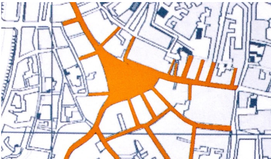
Fig. 586 Dit typisch de ontwerp schaal om een voetgebied met zijn routing tussen herkomstpunten ( H ) zoals het station en bestemming ( B ) het centrale plein te reserveren en de profielen te beschrijven (Dank aan gemeente 's Hertogenbosch).
