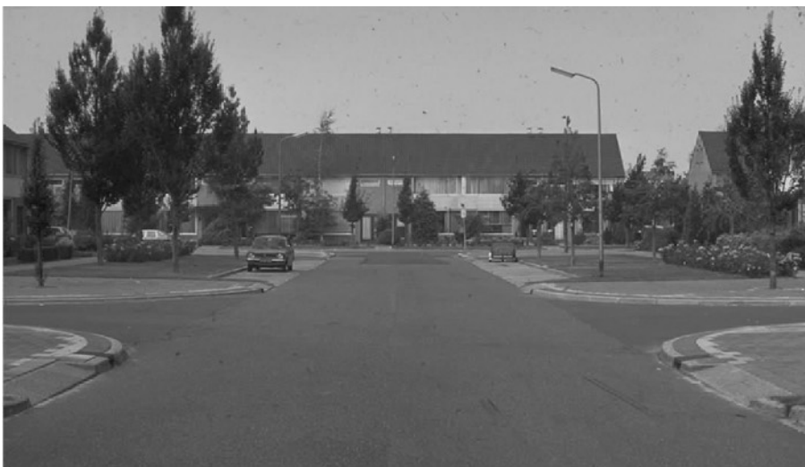
Fig. 614 a & b In Vleuten-De Meern knipte men in 1984 een sluiproute hartje woonwijk door; het ASVV (2004) geeft een serie technische oplossingen tegen sluiptverkeer als men op structuurniveau besluit (bijvoorbeeld ten gunste van grotere verblijfsgebieden) de maaswijdte van de hoofdwegen grover te maken (ETW en / óf GOW). Midden jaren tachtig voorkwam men reeds dat het doorknippen van sluiproutes het fietsverkeer benadeelt, maar men dacht nog niet aan voetroutes, geschikt voor kinderwagens en invaliden.
