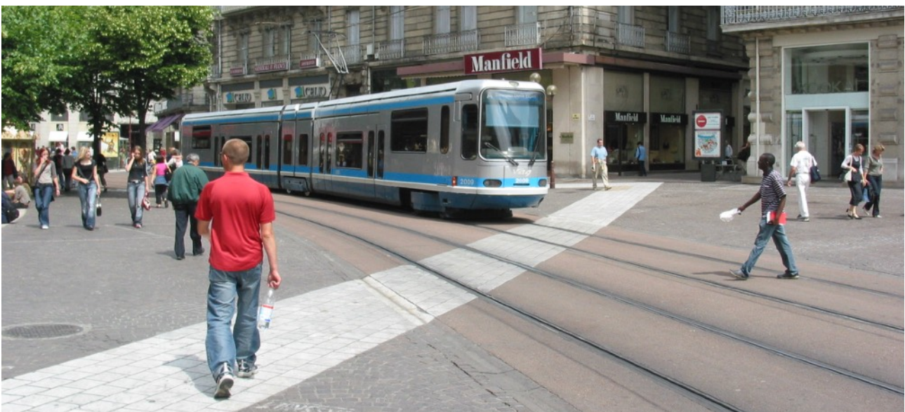
Fig. 373 Integratie collectief vervoer met lopen en kopen in de binnenstad van Grenoble (F) gebaseerd op spontane oversteekbewegingen; dwarsprofiel zonder hoogteverschil. 50km/u.
