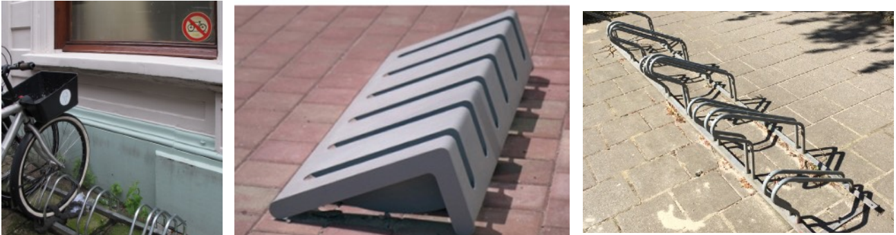
Fig. 501 a t/m c Te veel traditionele fietsenrekken zijn gebaseerd op voorwiel-inklemming (kans op 'n slag in 't wiel) en de hart-op-hart maat is te smal voor moderne fietsen.
