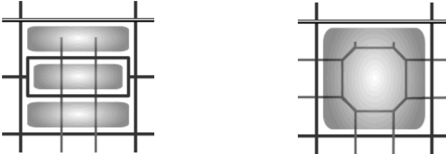
Fig. 256 en 256 Bij congestie spreidt een grid de overmaat aan auto's. Ook kan men in een grid gemakkelijk verkeersvrije plekken oprekken of omsluiten.
