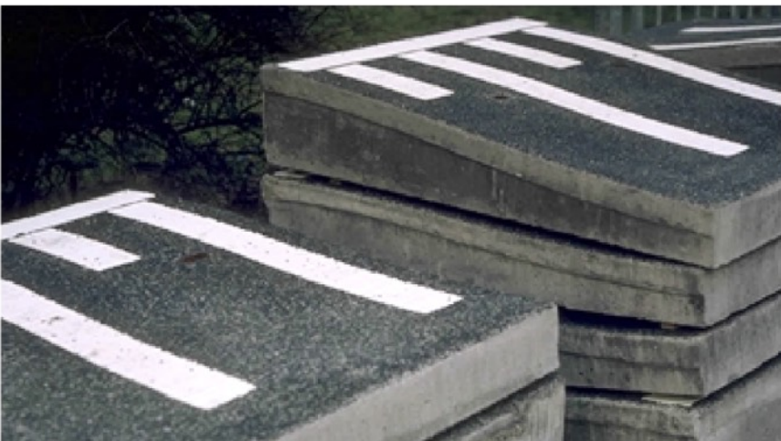
Fig. 146 Drempels zijn effectieve snelheidsremmers, maar worden gehaat door velen, wekken trillingen op in woningen en zijn vooral bij slappe bodem onderhoudsgevoelig; de passeersnelheid is beter te regelen met Pre-Fab drempels. Mits goed toegepast geven ze minder trillingshinder dan gestraatte drempels.
