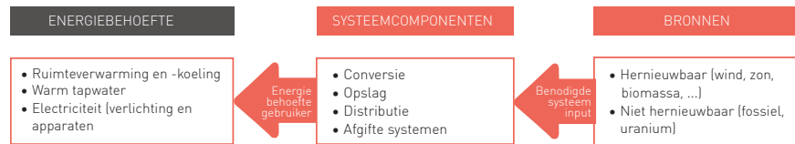
FIG. 1 Keten voor energievoorziening in de gebouwde omgeving [1].
