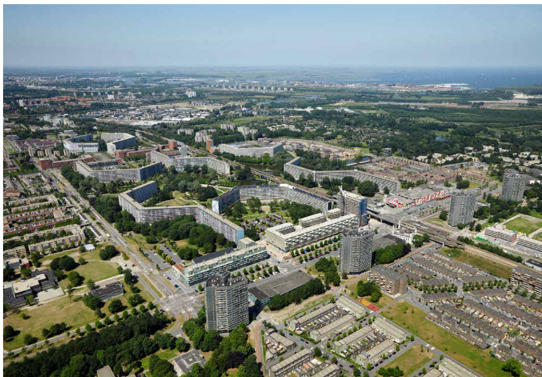
AFBEELDING 6.7 Deelplan D en E van de Bijlmermeer in 2011 gezien vanuit het zuiden, met de resterende hoogbouw (met lange galerijen op elke verdieping in plaats van één ontsluitende binnenstraat ) en buurtcentrum en metrostation Kraaiennest, maar met veelal afgebroken drooglopen en garages , en met verlaagde Karspeldreef en vervangende laagbouw .
